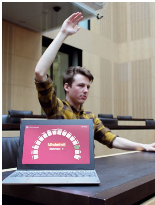
Thomas Wagner demonstriert eine Stimmabgabe im Bundesrat: Das Kamerasystem erkennt die Geste des Handhebens und stellt sie als gültige Stimme visuell am Bildschirm dar (hier grün).
