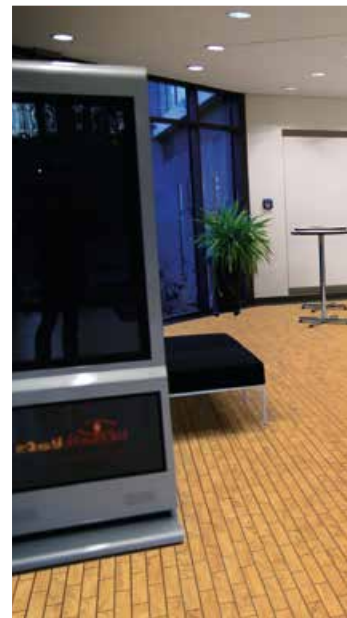
Bild 4: Foyer mit Parkettbelegung nach Englischem Verband und Sortierung der Elemente nach den Parametern Farbton und Standardabweichung (Strukturiertheit)
