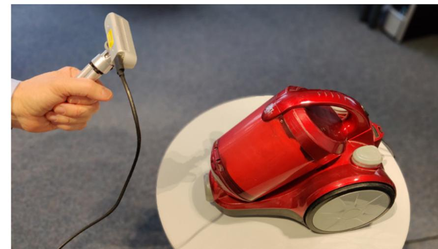
▲ Scannen eines Messobjekts mit Hilfe der „RealSense“-Tiefenkamera.
