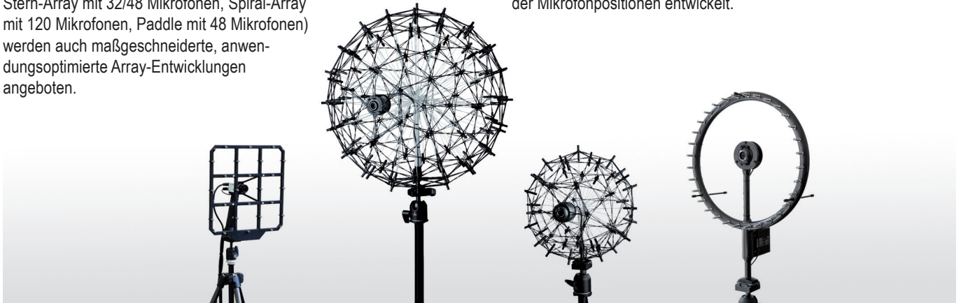
Verschiedene Mikrofonarrays (v. l. n. r. : Paddle2x24, Sphere120, Sphere48, Ring32)
