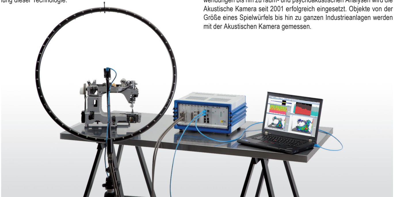
Typische Systemkonfiguration Akustische Kamera: Mikrofon-Array, Datenrekorder und Laptop mit Software NoiseImage
