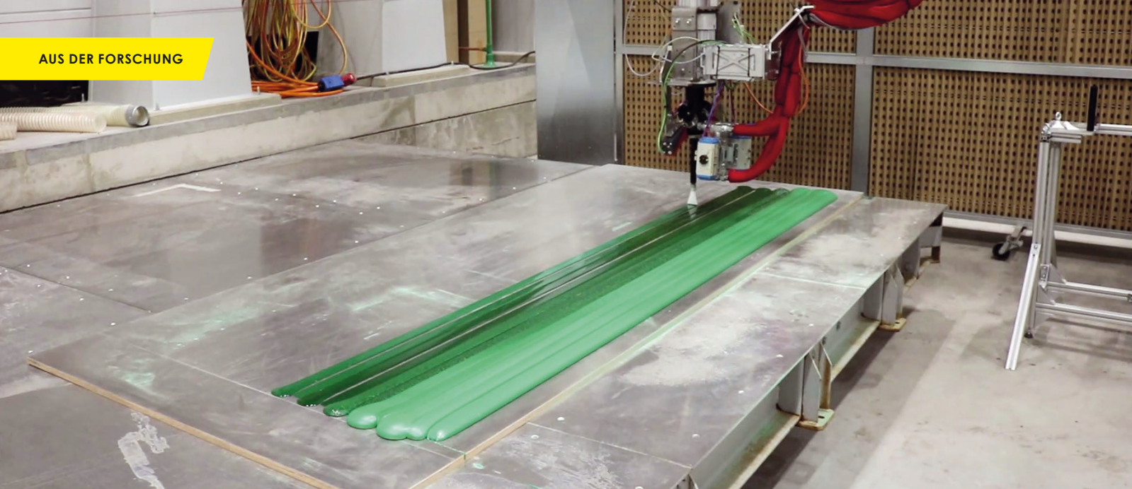
Druckversuch Negativform für ein Windkraftanalagenflügelblatt auf der Zielanlage
