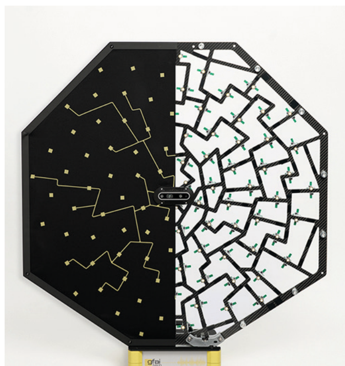
Unter dem Stoffbezug des Octagons verbirgt sich eine Metallkonstruktion mit präzise platzierten Mikrofonen
