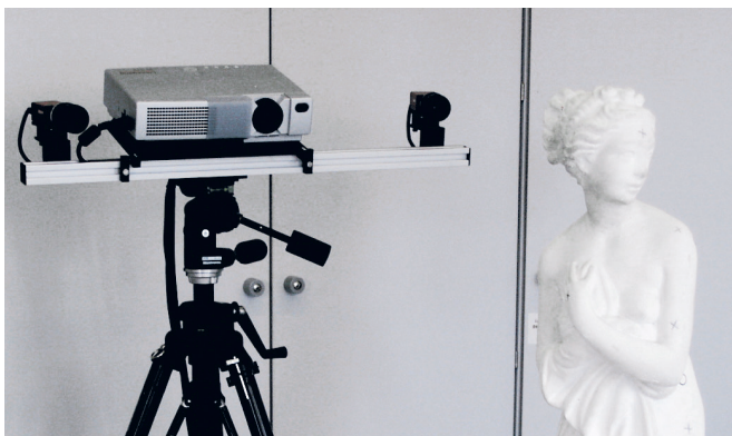
Objektvermessung mit ScanMobile
