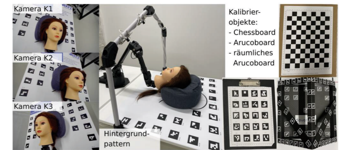
Abb. 4. Demonstrator aufgenommen von 3 Kamerapositionen (links); positionierbarer Puppenkopf und Hintergrundpattern (Mitte); Kalibrierobjekte zur Kalibrierung des Demonstrators (rechts) [Riedel et al., 2022]
