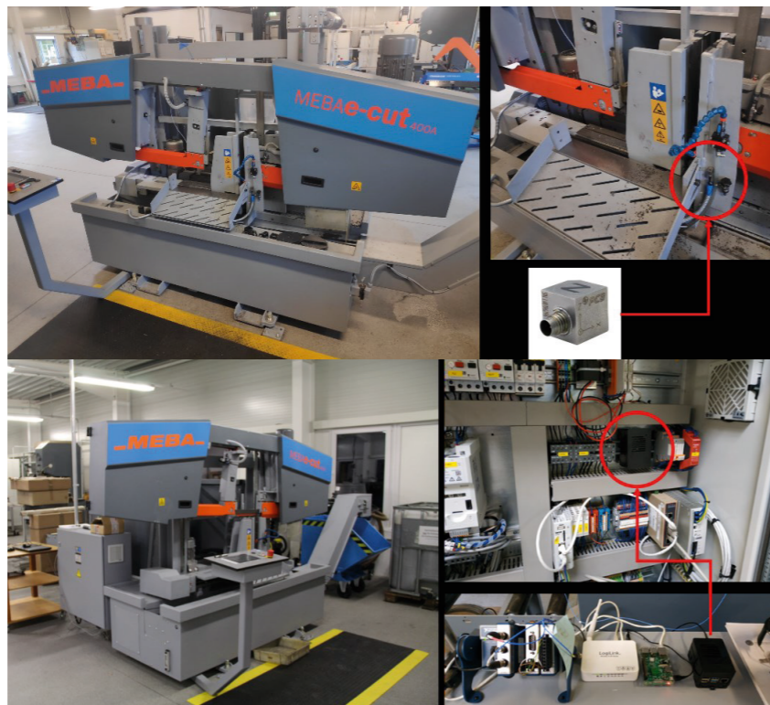
Figure 1: MEBA-Bandsäge e-cut 400A mit Sensor ICP 356A02 der Firma PCB.
