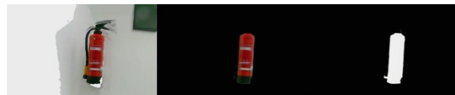
Abbildung 5: Ergebnis der Segmentierung: Links: Auswahl des Objekts in der Szene; Mitte: Segmentierungsergebnis (RGB); Rechts: Segmentierungsergebnis (Tiefenbild)
