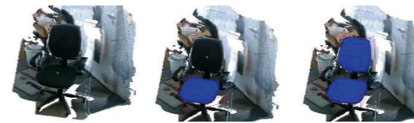
Abbildung 9: Erweiterung der Bounding Box: Links: Auswahl eines Punktes für den ersten Prozessdurchlauf; Mitte: Auswahl eines Punktes für den zweiten Prozessdurchlauf; Rechts: angepasste Bounding Box
