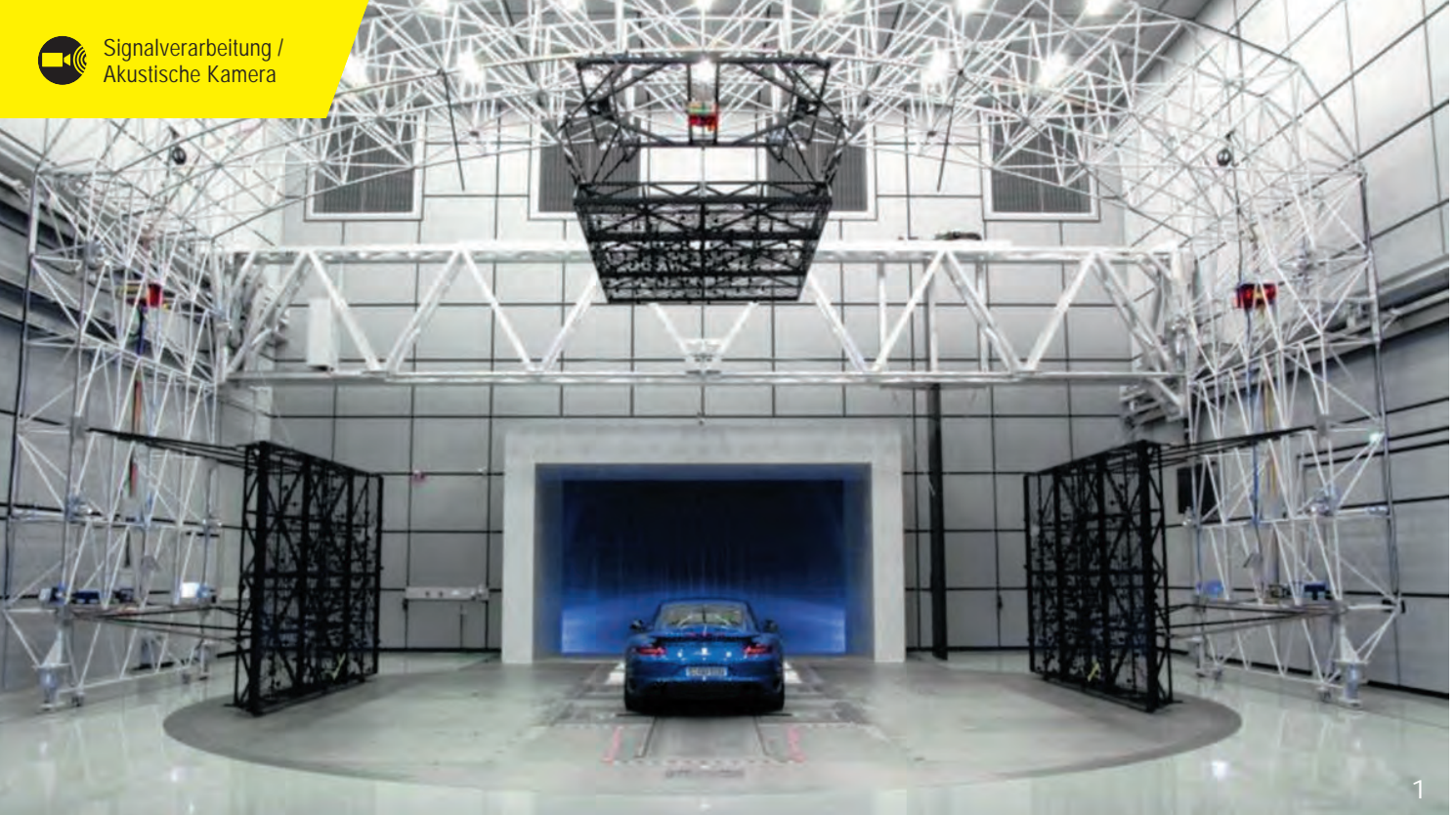
Bild 1: Arrays und Schwenkeinrichtung in Messposition [1]
