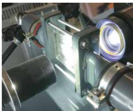
Durchlicht-Aufnahmetechnik: Gleichzeitige Durchleuchtung und Bildaufnahme des durchfließenden Abwassers mit Flockungsmittel
