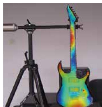
Augmented Reality Darstellung von drei Eigenschwingungsformen einer Kirchenglocke, einem PC-Gehäuse und einer Gitarre mittels der Software Wavelmage Modal
