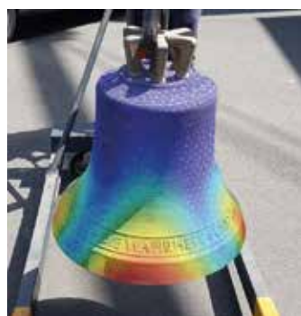
Augmented Reality Darstellung von drei Eigenschwingungsformen einer Kirchenglocke, einem PC-Gehäuse und einer Gitarre mittels der Software Wavelmage Modal
