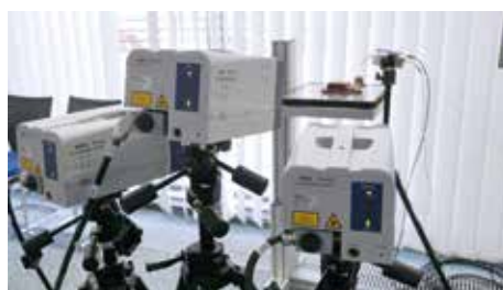
Die PolyTec-Laservibrometer: mit ihnen können Schwingungen in 3D gemessen werden
