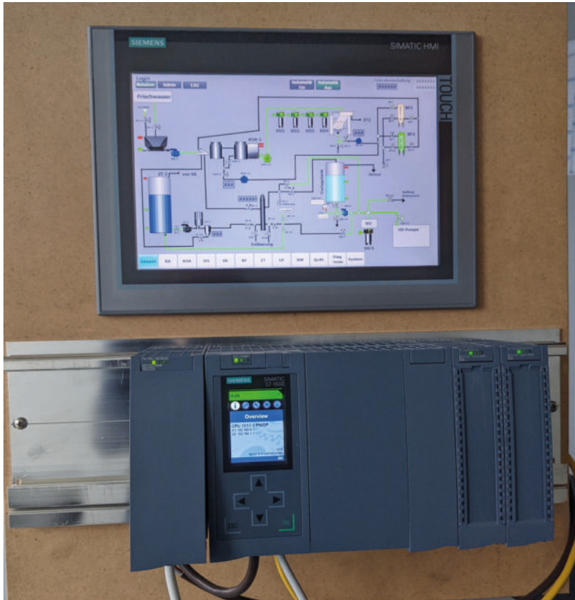
Simatic Testsystem mit der Gesamtansicht der Wasserstrahl-schneidanlage
